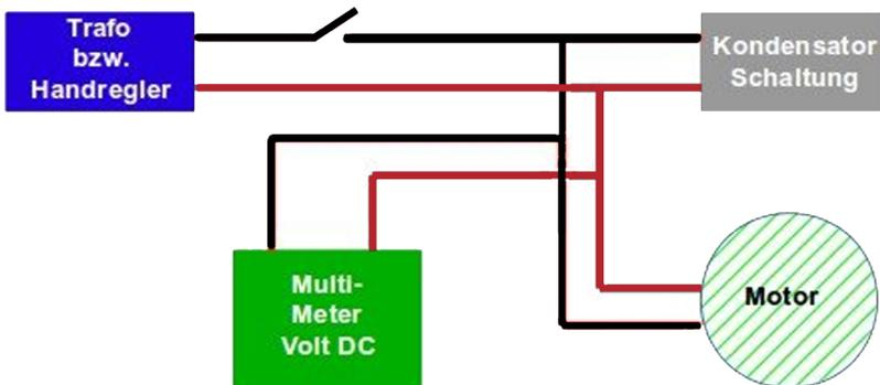
Bei geschlossenem Schalter werden die Kondensatoren aufgeladen. Wird der Schalter geöffnet, läuft der Motor noch etwas nach.
